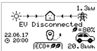
Le véhicule électrique n'est pas connecté à zappi.
